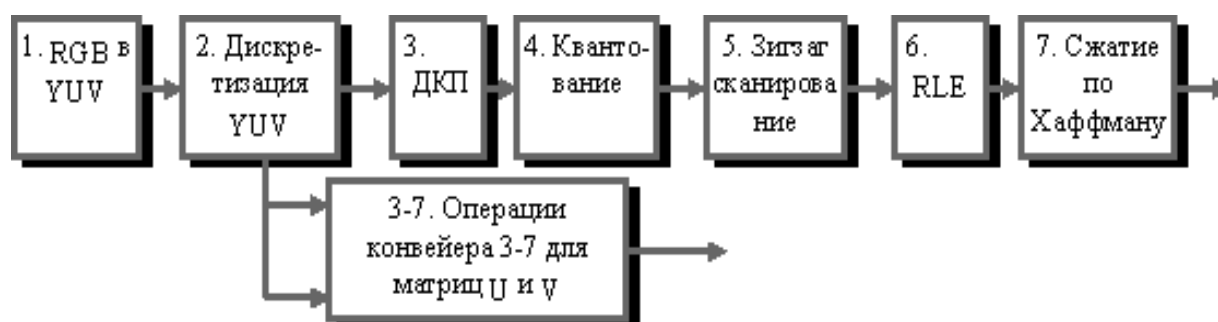
Рис. 2.1. Конвейер операций, используемый в алгоритме JPEG.
