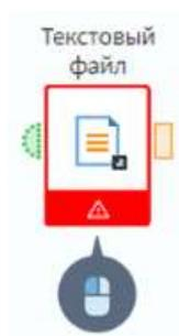
Рисунок 2.8 – Неуспешное состояние узла
