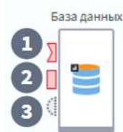
Рисунок 2.14 – Пример входных портов узла экземпляра компонента «База данных»
