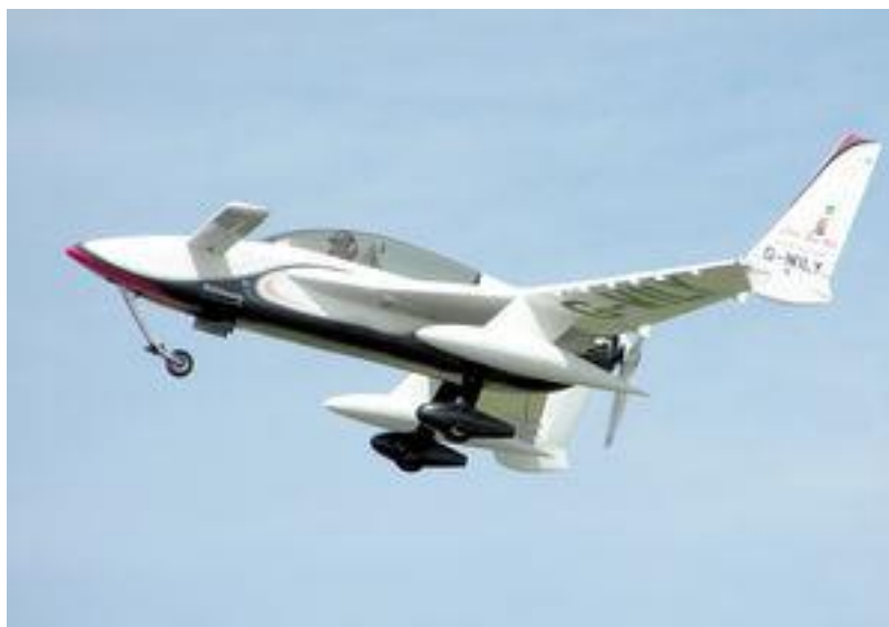
Рисунок 8.4 – Самолет, построенный по схеме «утка»
