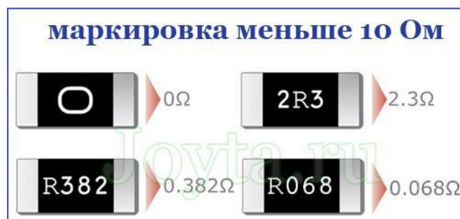
Рисунок 9.16 – Маркировка SMD-резисторов номиналом меньше 10 Ом
