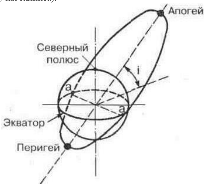
Рисунок 8.18 – Наклонная эллиптическая орбита ИСЗ
