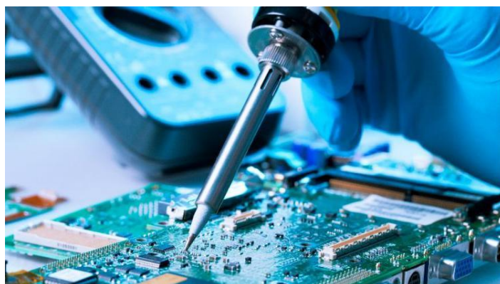
Рисунок 10.3 – Ручной монтаж печатной платы
