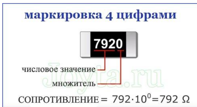
Рисунок 9.15 – Маркировка SMD-резисторов по четырем цифрам
