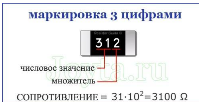
Рисунок 9.14 – Маркировка SMD-резисторов по трем цифрам
