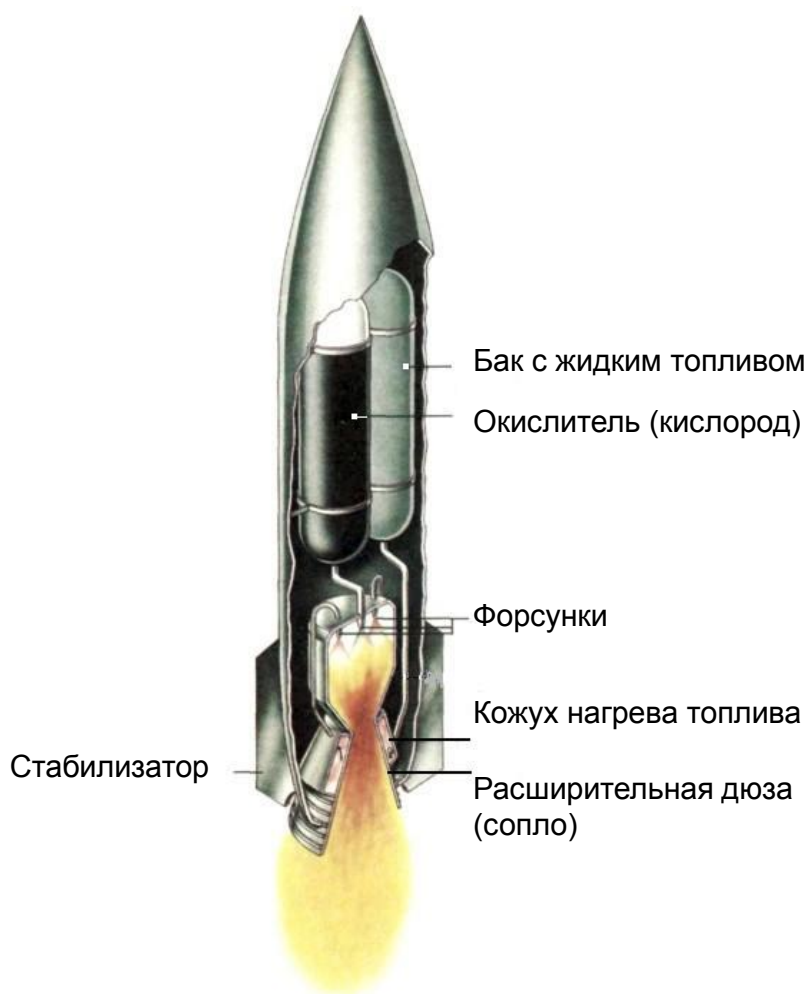
Рисунок 8.17 – Классическая конструкция одноступенчатой ракеты
