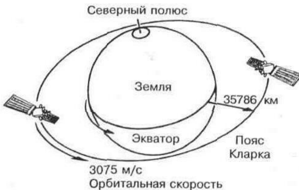
Рисунок 8.19 – Размещение геостационарных спутников Земли на поясе Кларка
