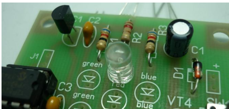
Рисунок 9.8 – Внешний вид выводных (ТНТ) компонентов на печатной плате. На картинке слева внизу видна DIP-микросхема, установленная на панели-«кроватьке»
