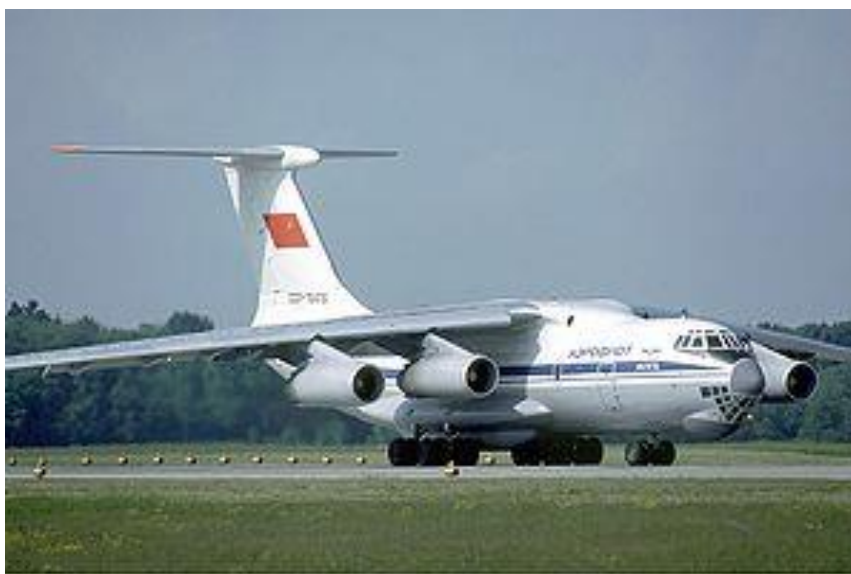
Рисунок 8.8. Ил-76, высокоплан с Т-образным оперением
