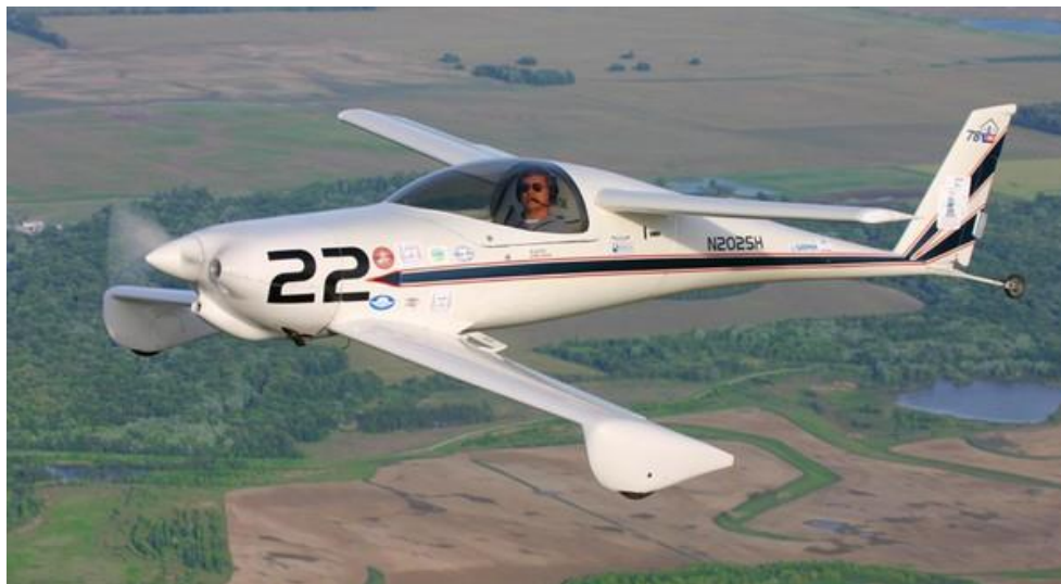
Рисунок 8.6 – Самолет, построенный по схеме «тандем»
