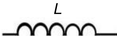
Рисунок 9.24 – Условное графическое обозначение катушки индуктивности
