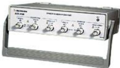
Прибор комбинированный АСК-4106 (далее — прибор) сочетает возможности осциллографа двухканального цифрового запоминающего и генератора сигналов произвольной формы двухканального цифрового. Прибор работает совместно с компьютером по интерфейсам USB 1.1 или LPT в режиме EPP.
