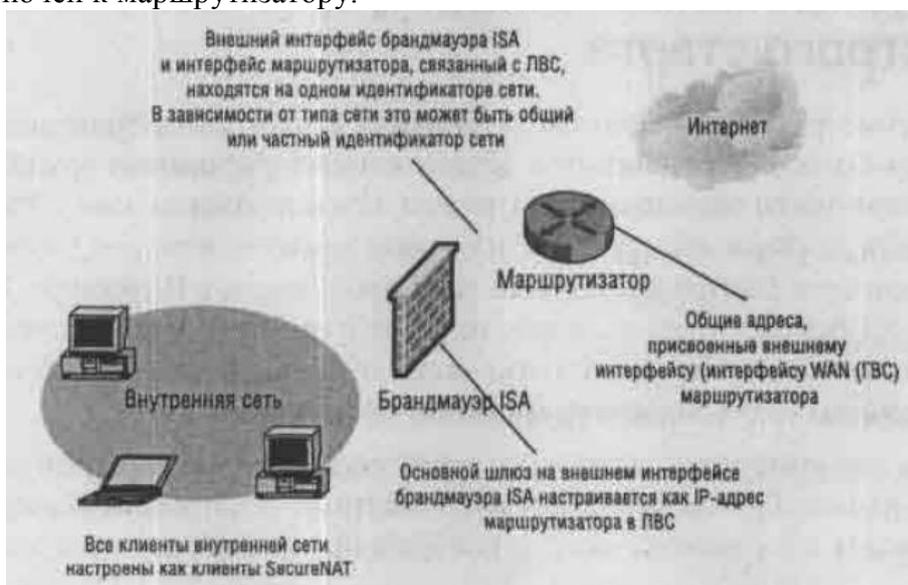
Рисунок 5. Физические связи между брандмауэром ISA Server 2004, внутренней и внешней сетью
