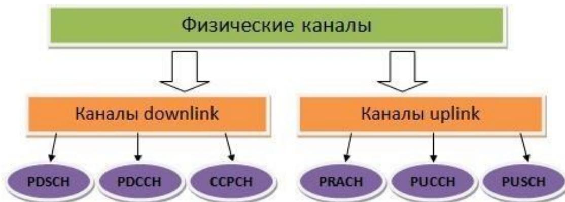
Рис. 5.70. Физические каналы LTE
