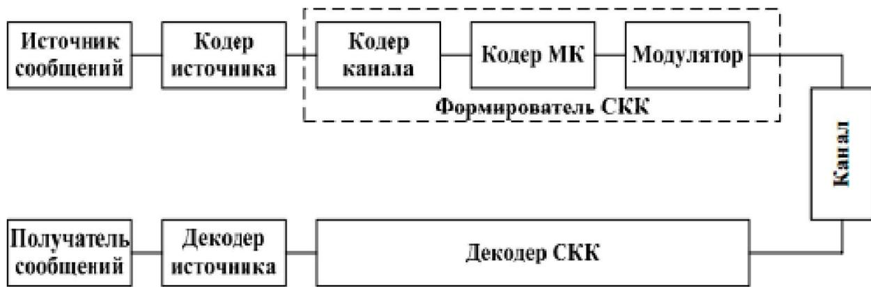
Рис. 4.2. Обобщенная схема передачи дискретных сообщений
