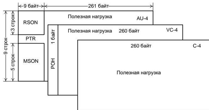
Рис. 6.2 – Структура модуля STM-1
