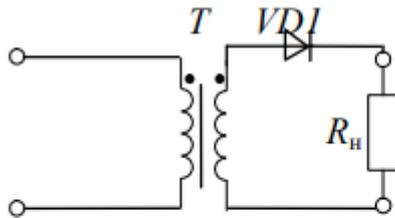
1. Однофазная однополупериодная
