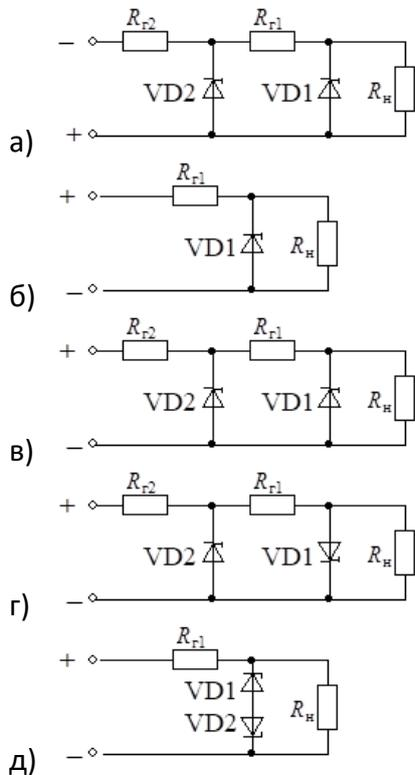
5. Чему равен коэффициент полезного действия стабилизатора, приведенного на рисунке, если:
