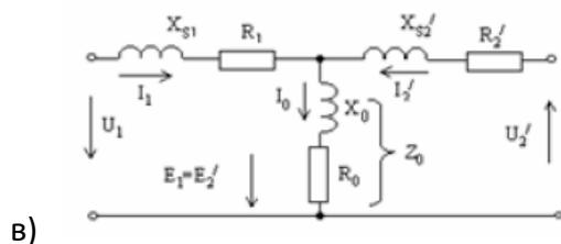
4. Укажите неверно обозначенные элементы схемы замещения трансформатора
