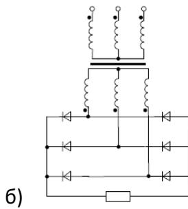
9. Амплитуда первой гармоники выпрямленного напряжения равна 5 В, а среднее значение напряжения – 100 В. Чему равен коэффициент пульсаций выпрямительной схемы?
