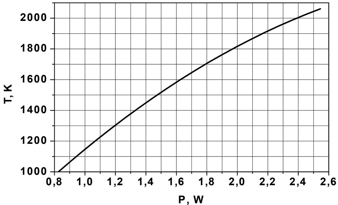
Рисунок 2.4 - Градуировочная кривая для определения температуры катода
