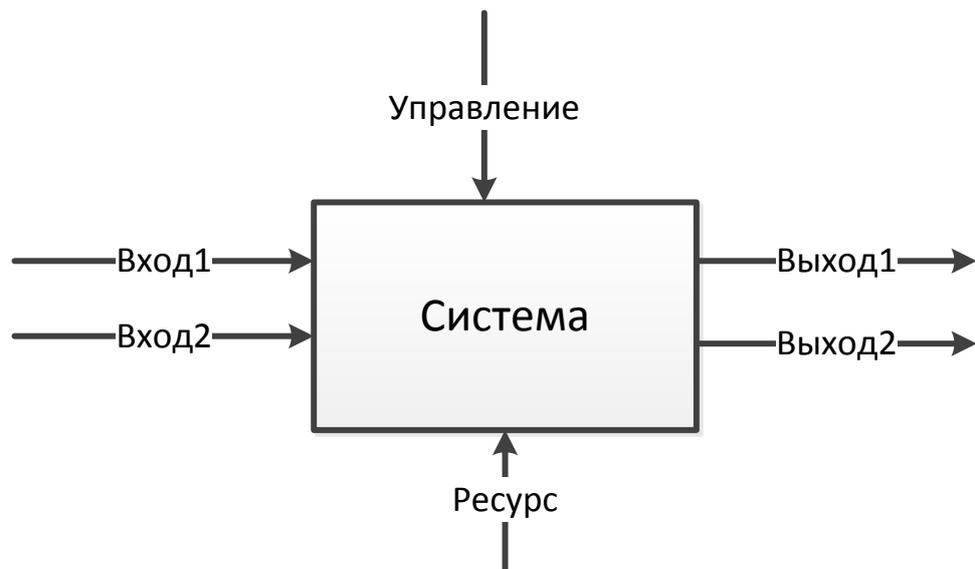
Рисунок 2 – Функциональная схема в формате IDEF0
