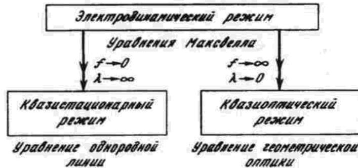
Рис. 2.4 Режимы передачи электромагнитной энергии по направляющим системам
