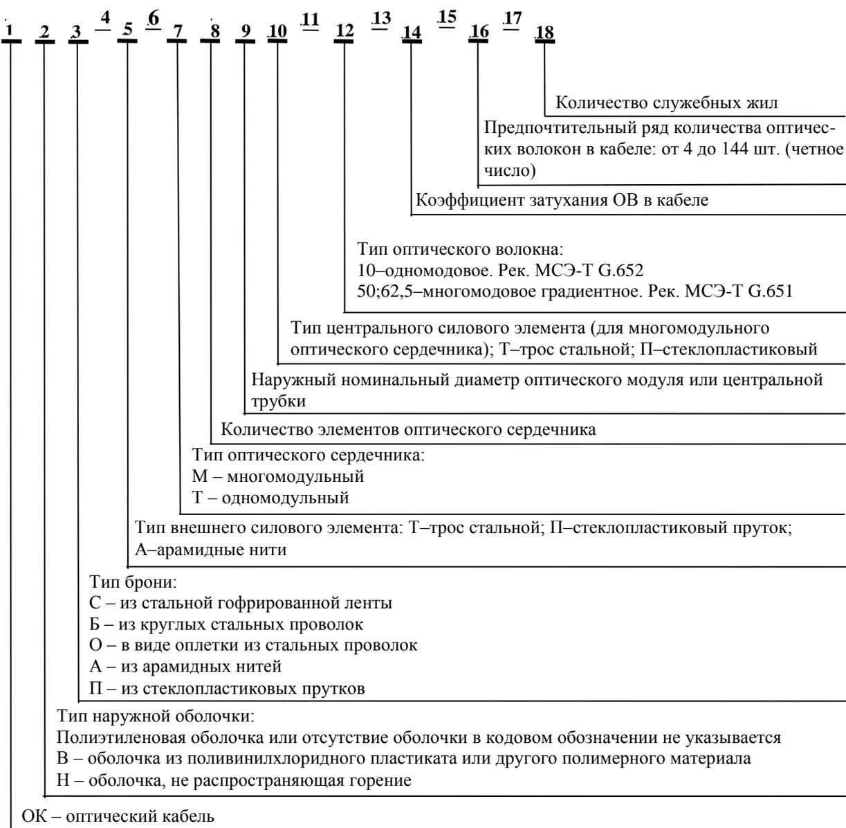
Рис. 8.2 Структура кодового обозначения марок кабелей
