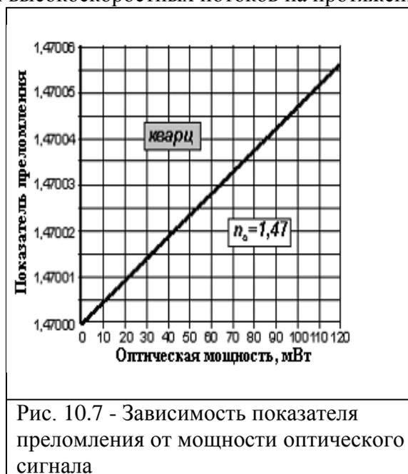
Рис. 10.7 - Зависимость показателя преломления от мощности оптического сигнала
