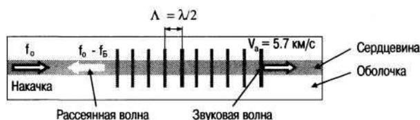
Рис. 10.4 – Схема рассеяния света на звуковой волне
