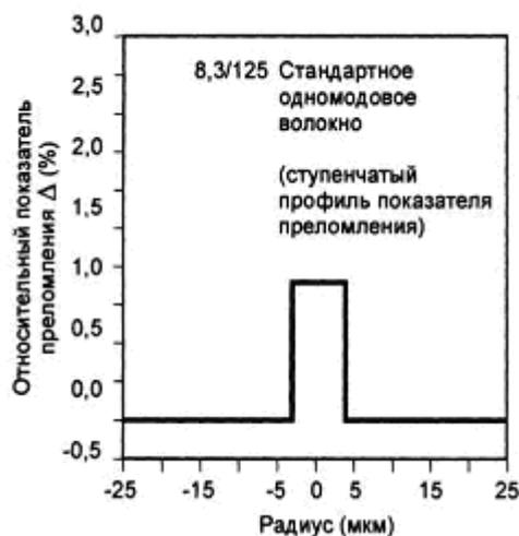
Рис. 7.1 – Профиль показателя преломления стандартного ОВ
