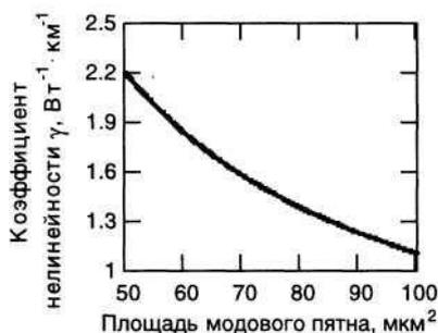
Рис. 10.3– Зависимость коэффициента нелинейности от диаметра модового пятна [17]
