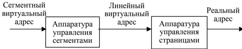
Рис. 34. Состав аппаратуры управления памятью
