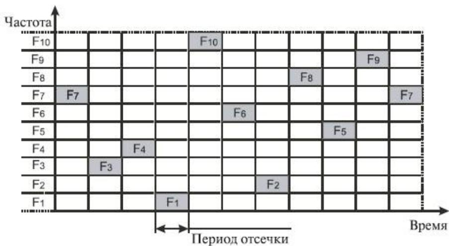
Последовательность перестройки частот: F<sub>7</sub>-F<sub>3</sub>-F<sub>4</sub>-F<sub>1</sub>-F<sub>10</sub>-F<sub>6</sub>-F<sub>2</sub>-F<sub>8</sub>-F<sub>5</sub>-F<sub>9</sub>-F<sub>7</sub>
