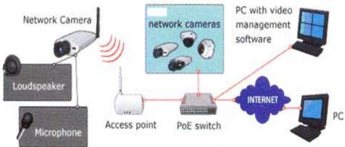
Рис. 2.1. Принцип действия беспроводного видеонаблюдения
