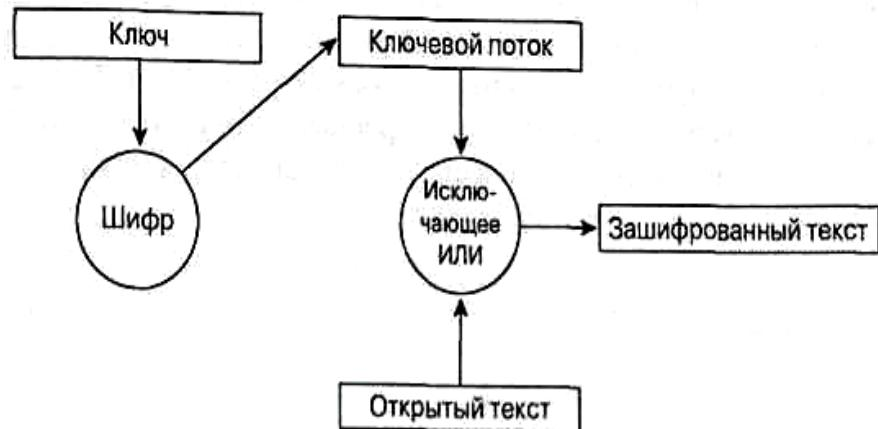
Рис. 1.5.1. Работа поточного шифра
