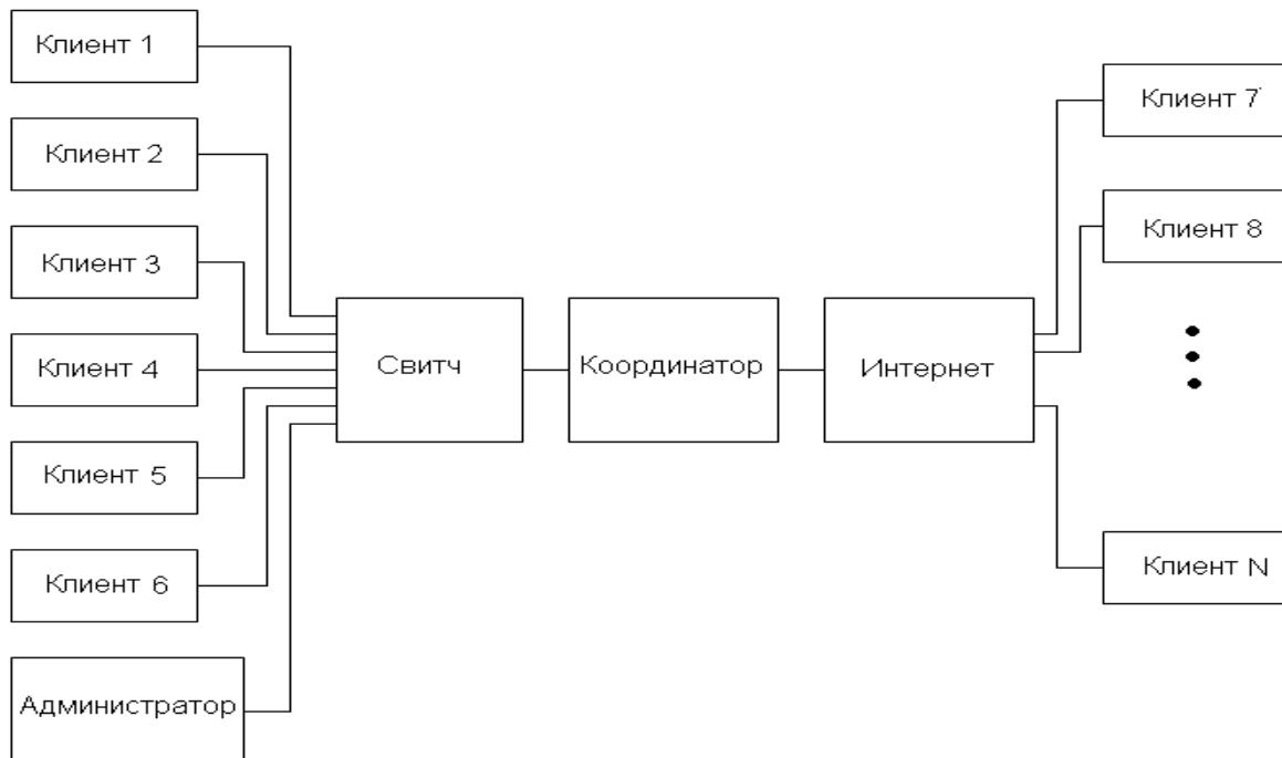
Рис. 83. Защищенная сеть на базе технологии ViPNet Custom
