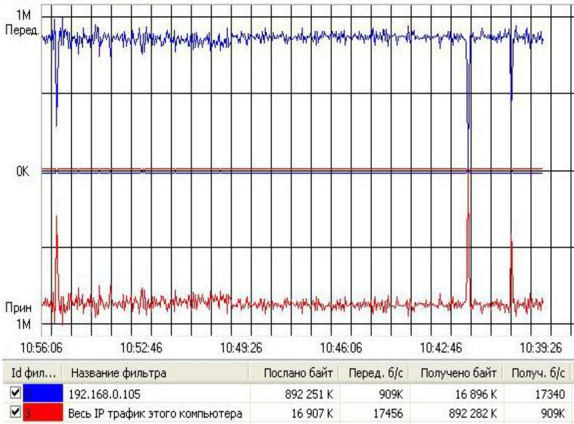
Рис. 3.5.4. Нагрузка на сеть при передаче динамичного изображения
