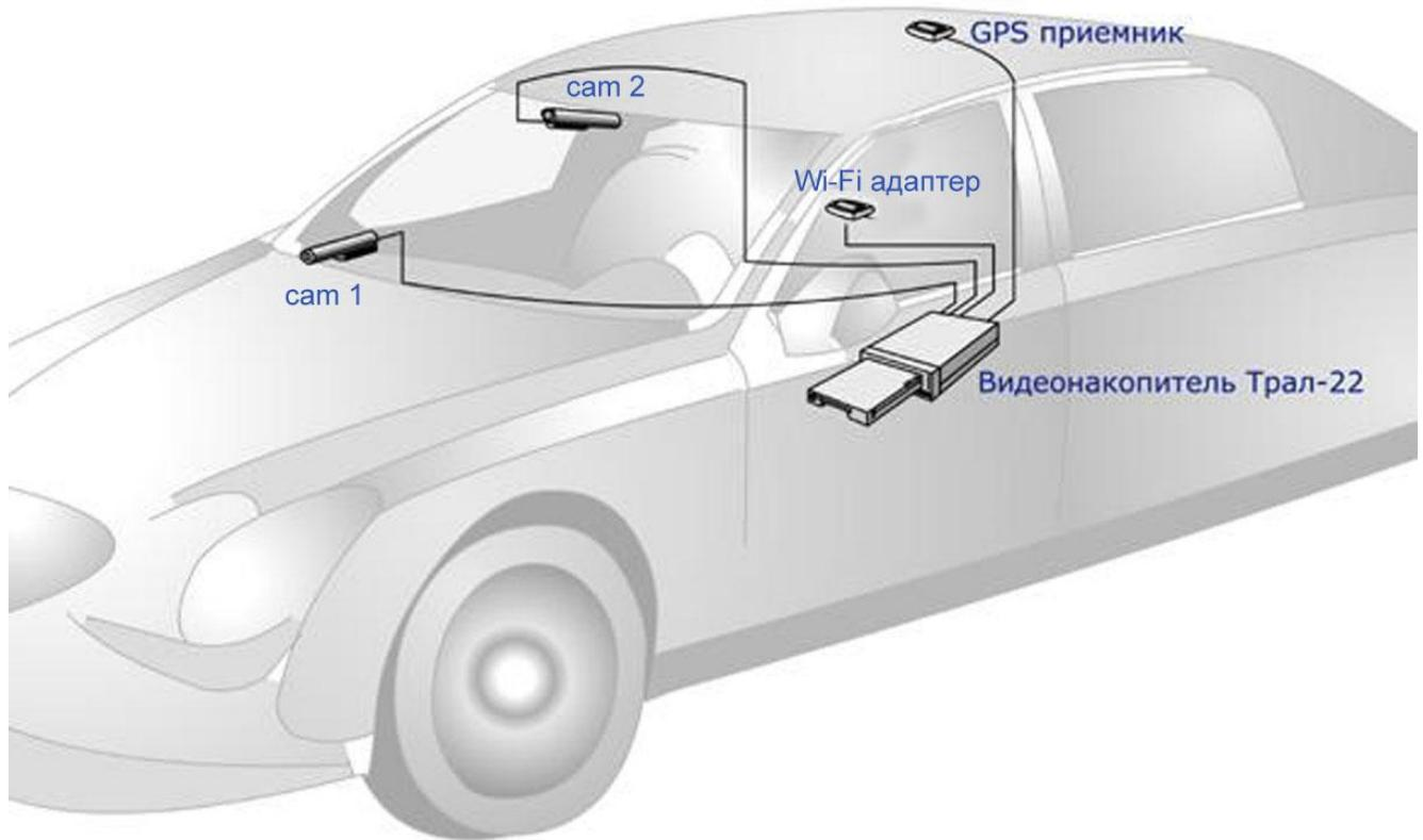
Рис. 2.2.3. Система видеонаблюдения в автомобиле
