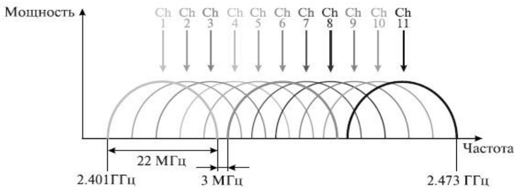
Рис. 1.4.5. Каналы, используемые в технологии DSSS
