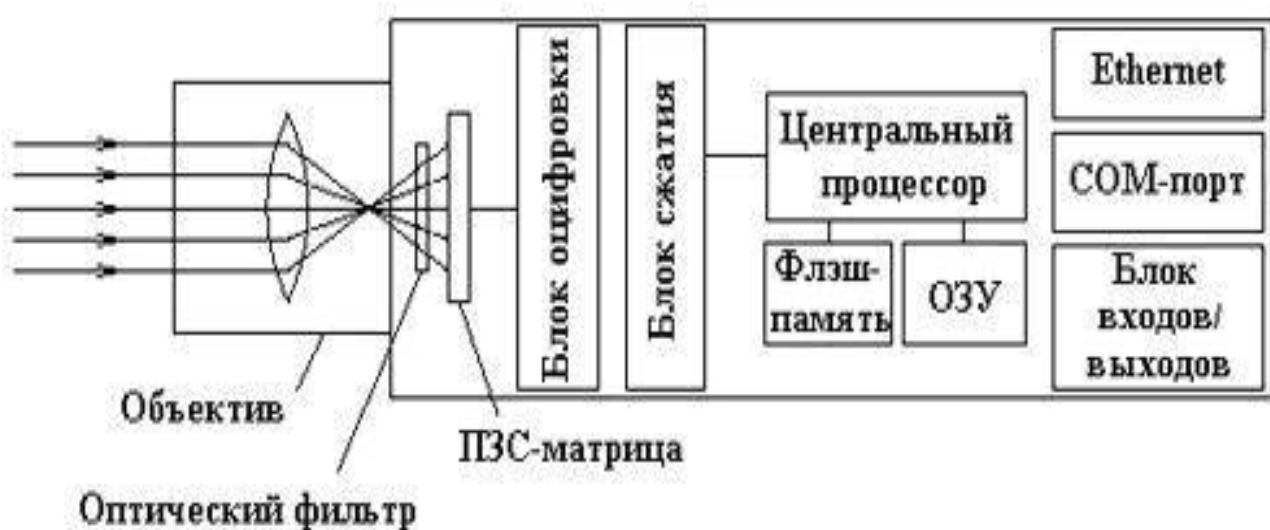
Рис. 2.4.1. Устройство IP-камеры
