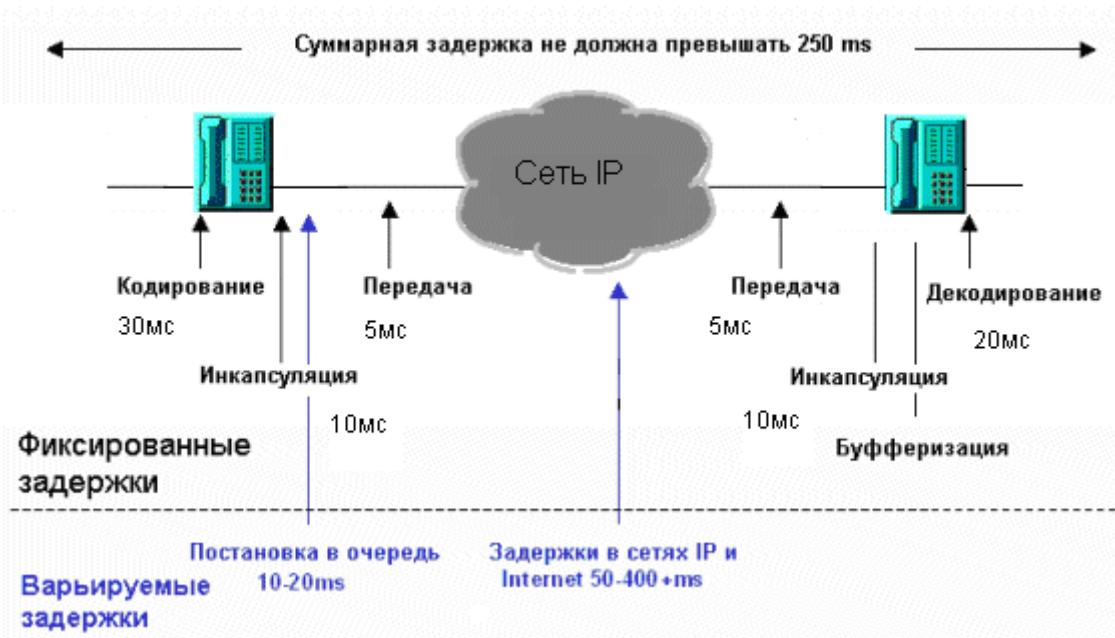
Рис. 14. Составляющие задержки в сети IP-телефонии
