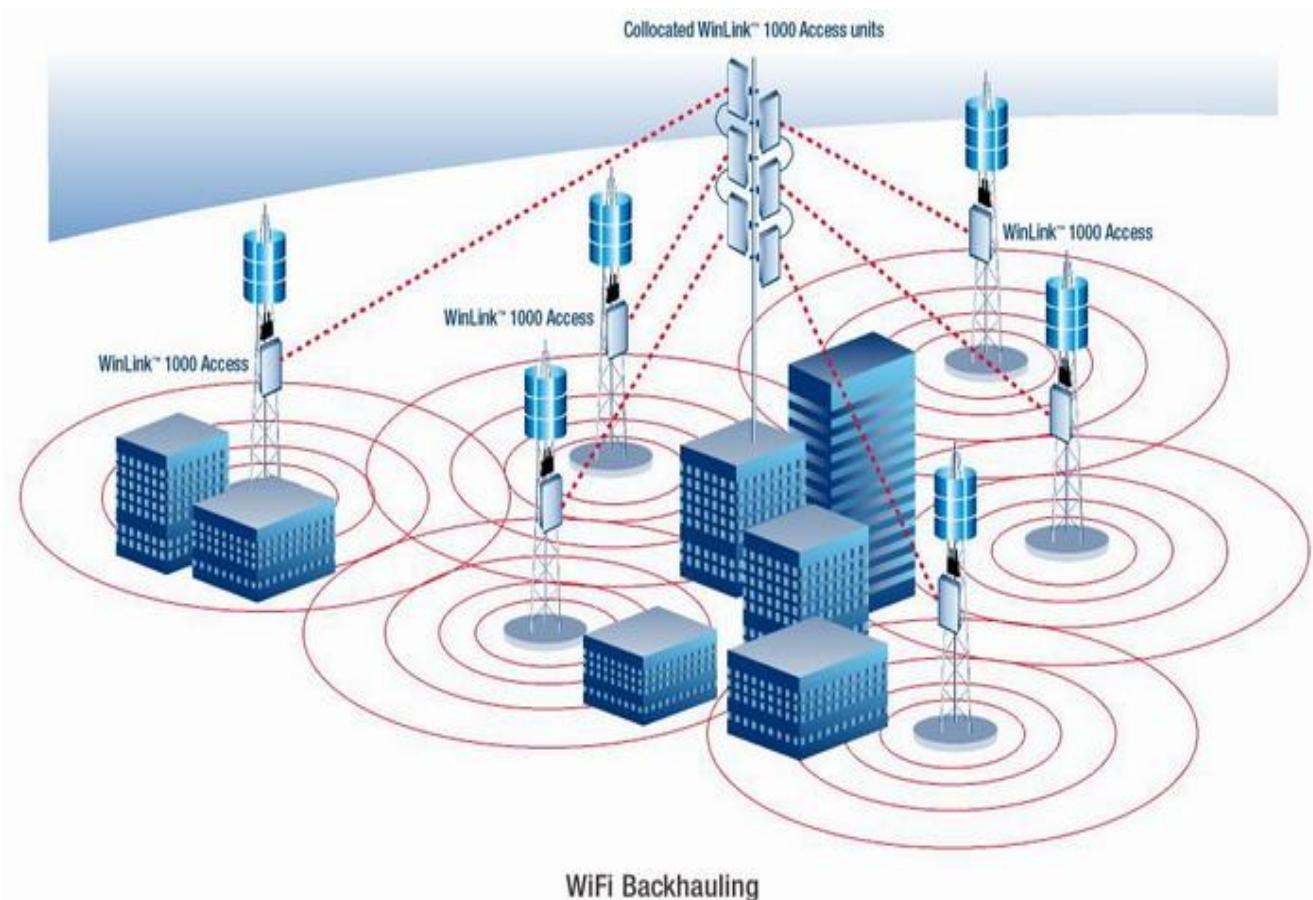
Рис. 2.3.2. Увеличение зоны покрытия при использовании системы ретрансляторов
