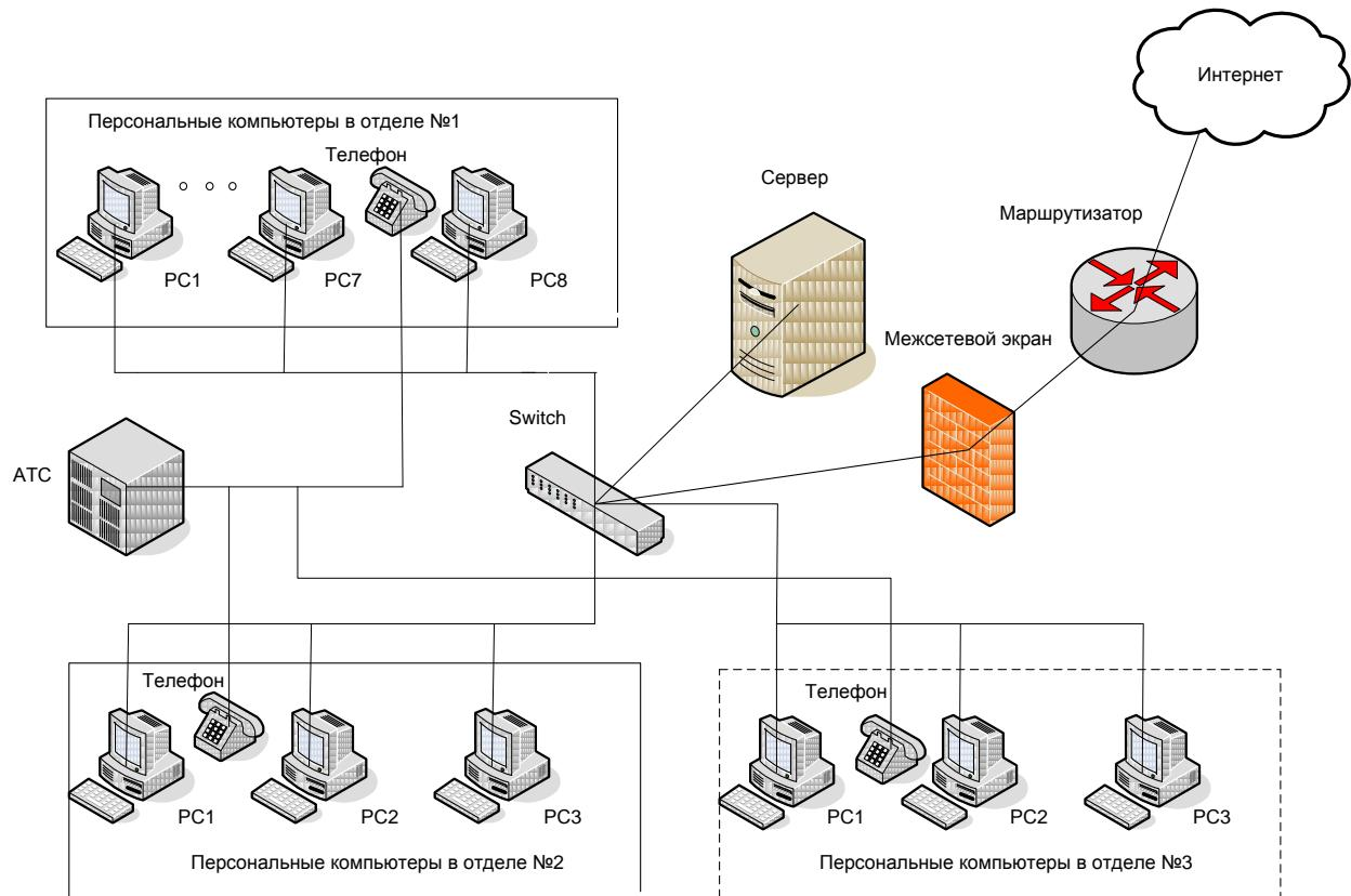
Рис. 7. Структура подсети НПФ «Микран» до внедрения IP-телефонии
