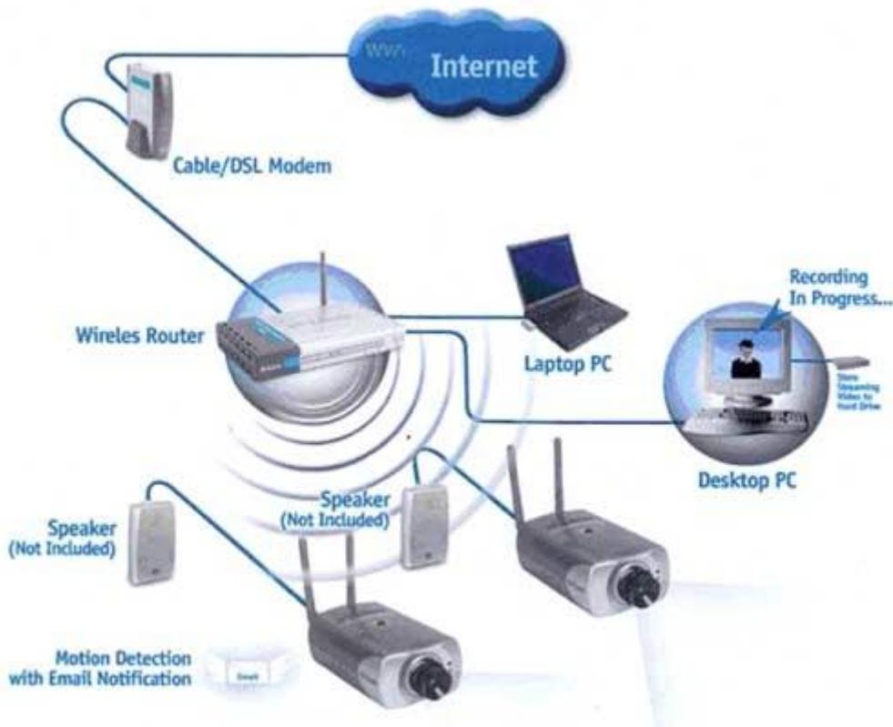
Рис. 2.3.1. Схема системы видеонаблюдения, с применением Wi-Fi
