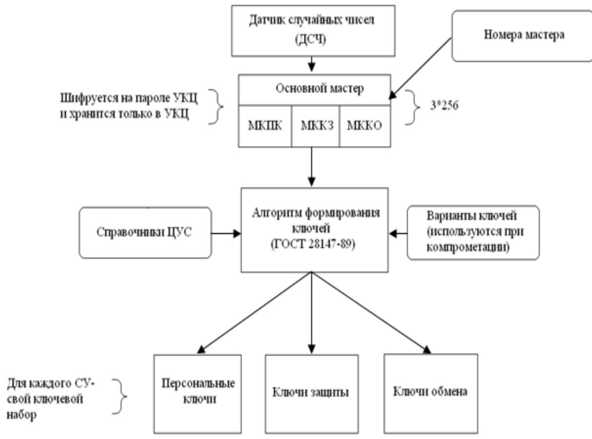
Рис. 5. Формирование симметричных ключей шифрования и идентификации
