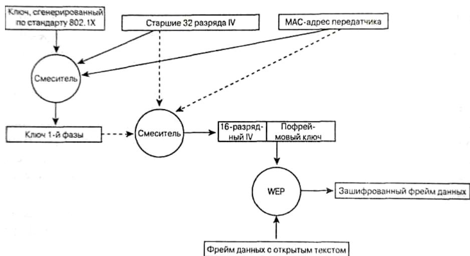
Рис. 1.6.5. Процесс Пофреймового изменения ключа
