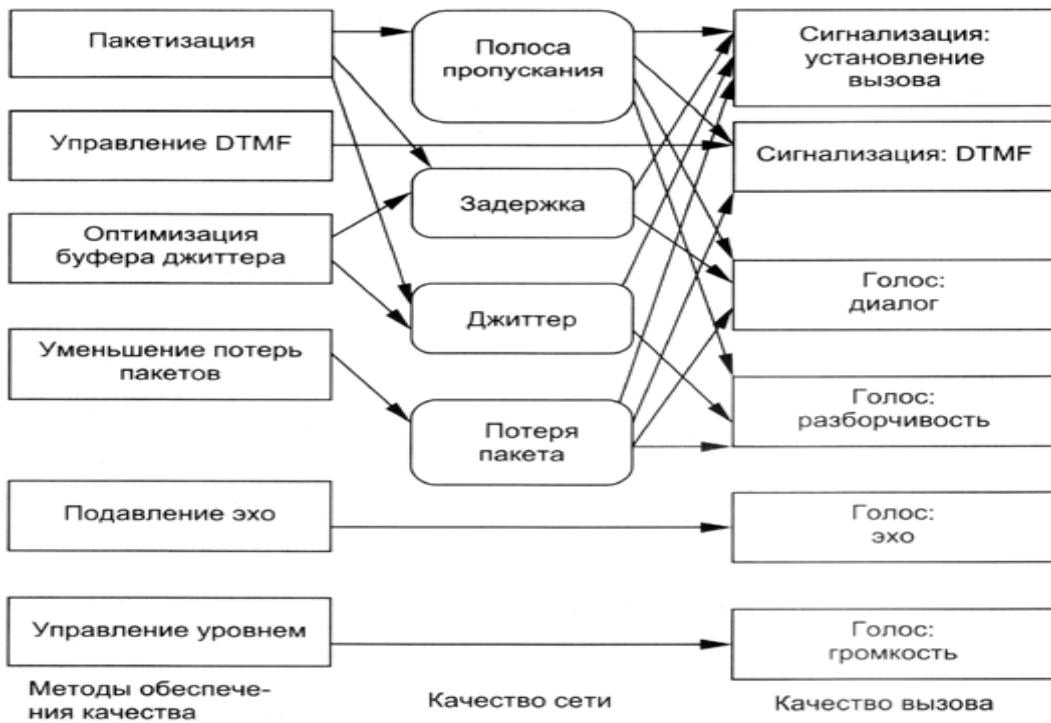
Рис. 5. Схема обеспечения качества IP-телефонии
