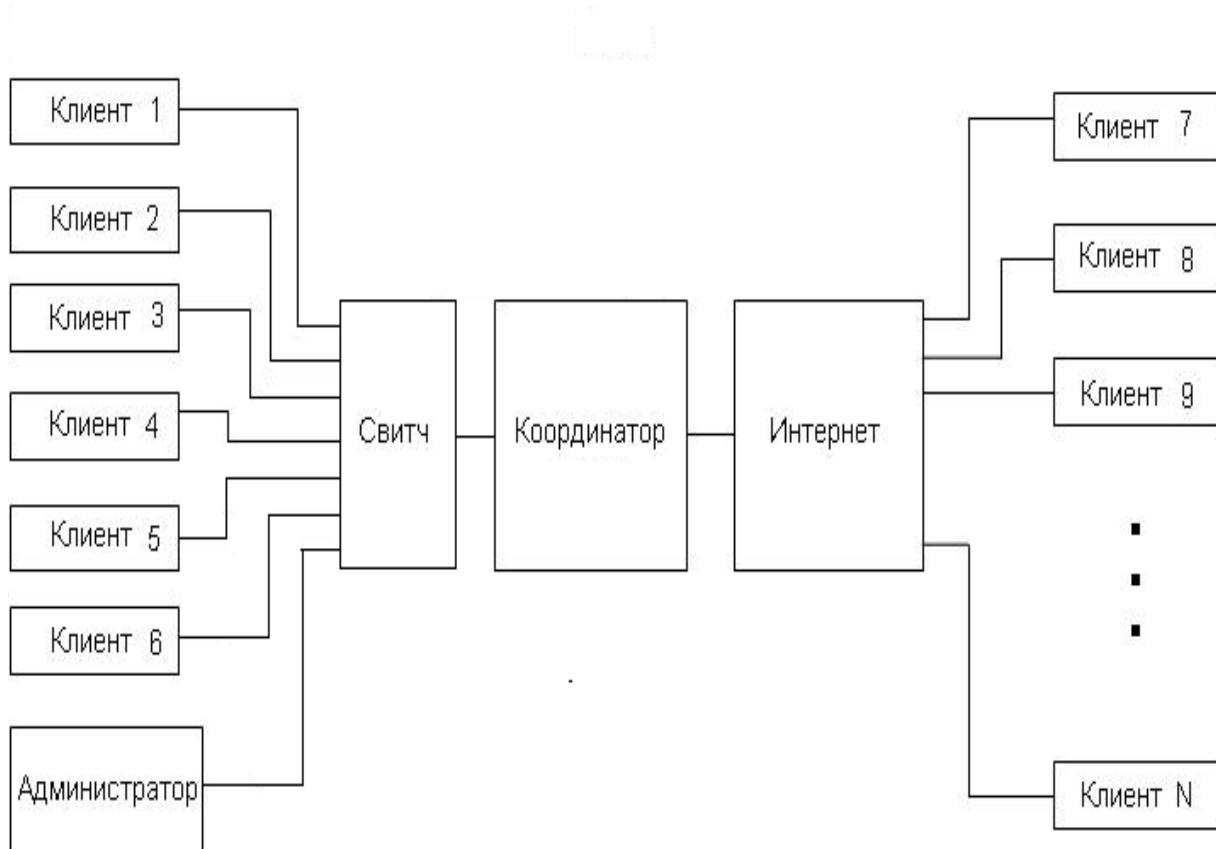
Рис. 21. Структурная схема защищенной сети ViPNet Custom.
