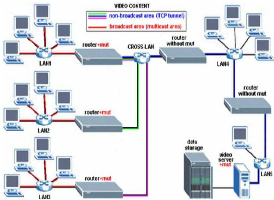
Рис. 2.7.2. Пример построения сети с использованием IP мультикаст
