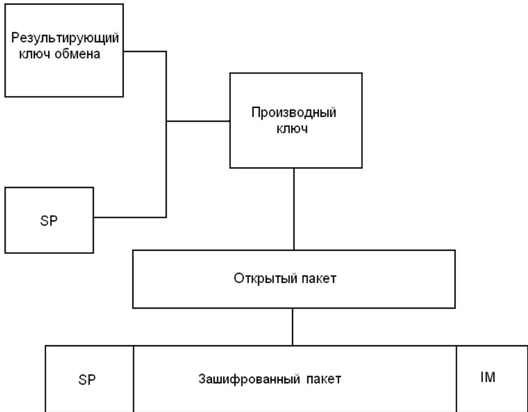
Рис. 23. Шифрование IP-пакета на сетевом уровне.
