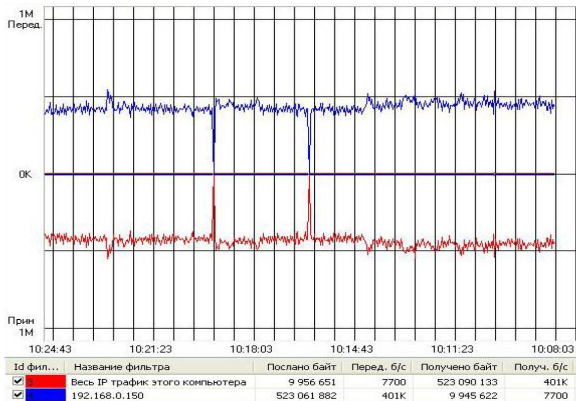
Рис. 3.5.3 Нагрузка на сеть при передаче статичного изображения
