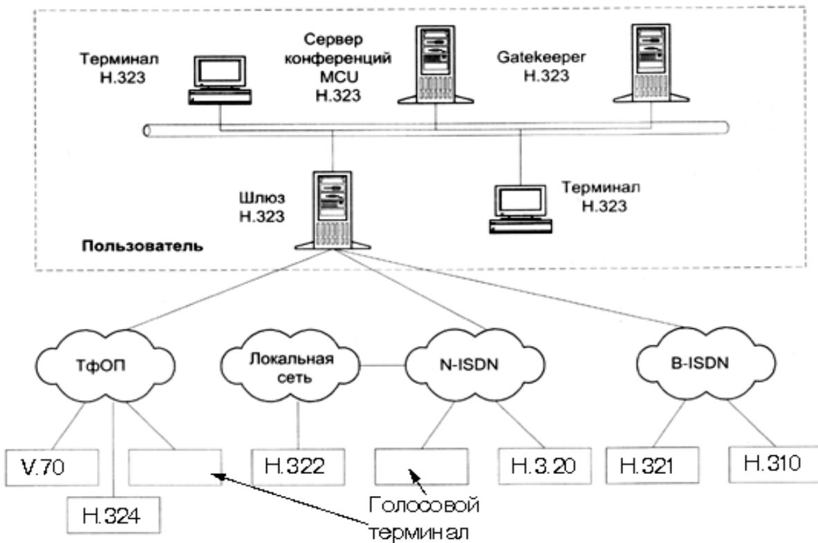
Рис. 2. Конфигурация сети на базе стандарта H.323
