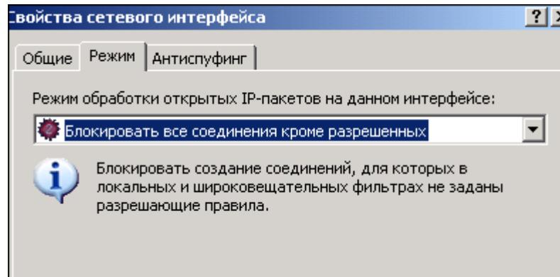
Рис. 64. Режим безопасности сетевого интерфейса
