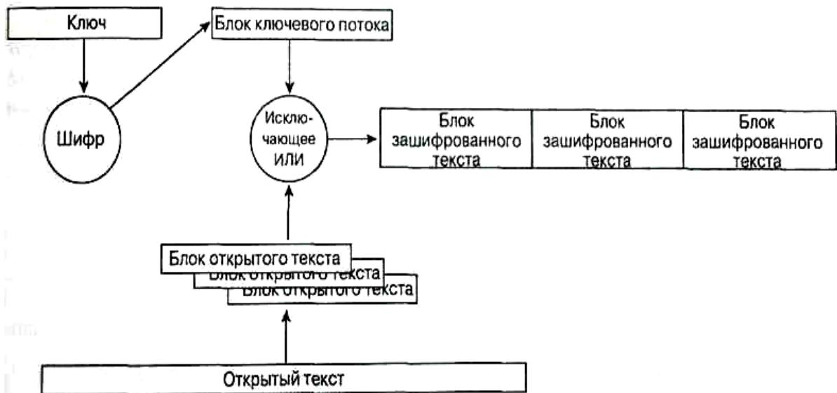
Рис. 1.5.2. Работа поточного блочного шифра.
