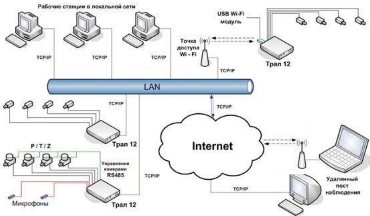
Рис. 2.2.2. Система видеонаблюдения интегрированная в локальную сеть учреждения
