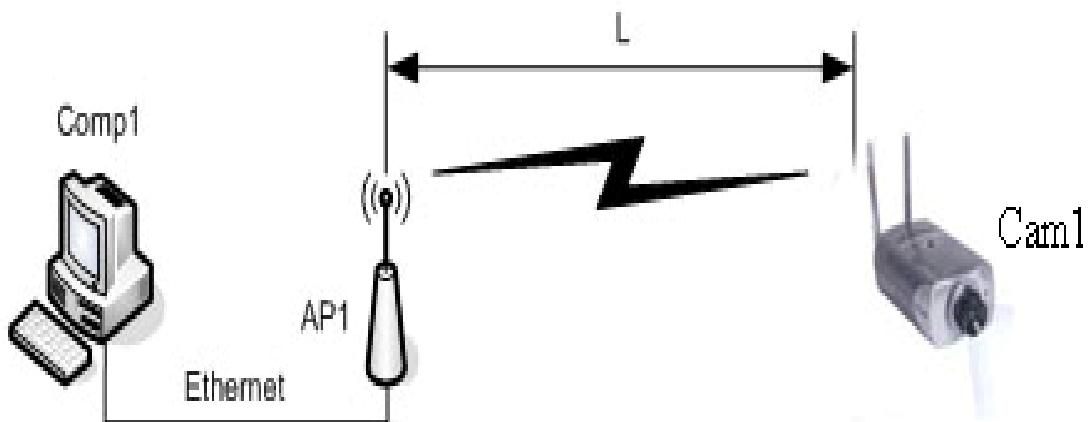
Рис. 3.5.2. Тестовый стенд для определения максимальной пропускной способности точки доступа.
