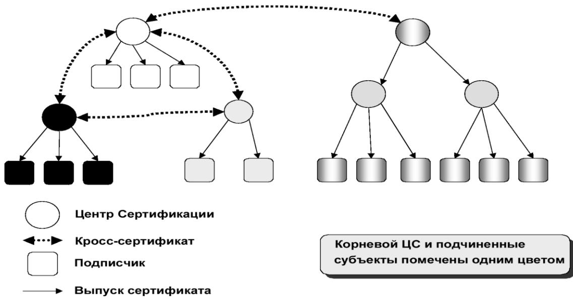
Рис. 14. Гибридная PKI
