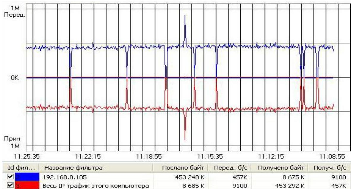
Рис. 3.5.5. Неравномерность нагрузки на сеть при передаче изображения
