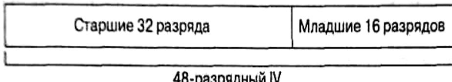
Рис. 1.6.4. Разбиение на части IV для использования при пофреймовом изменении ключа
