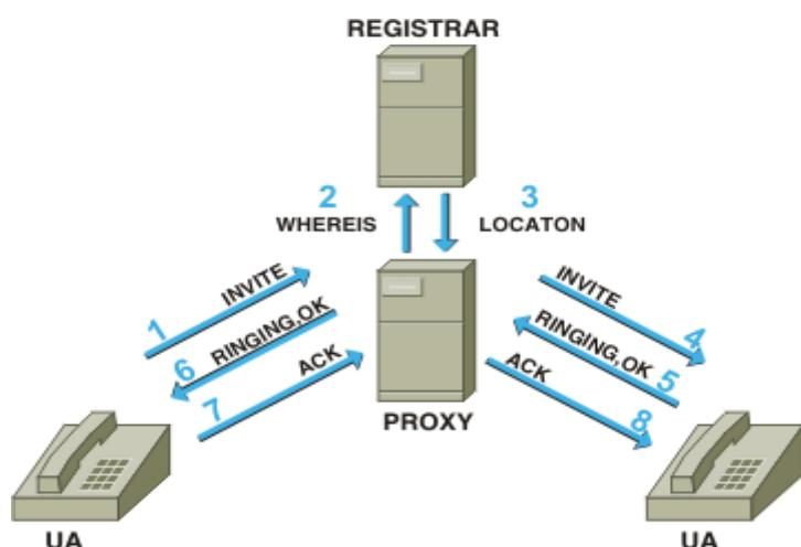
Рис. 4. Схема сигнализации по протоколу SIP
