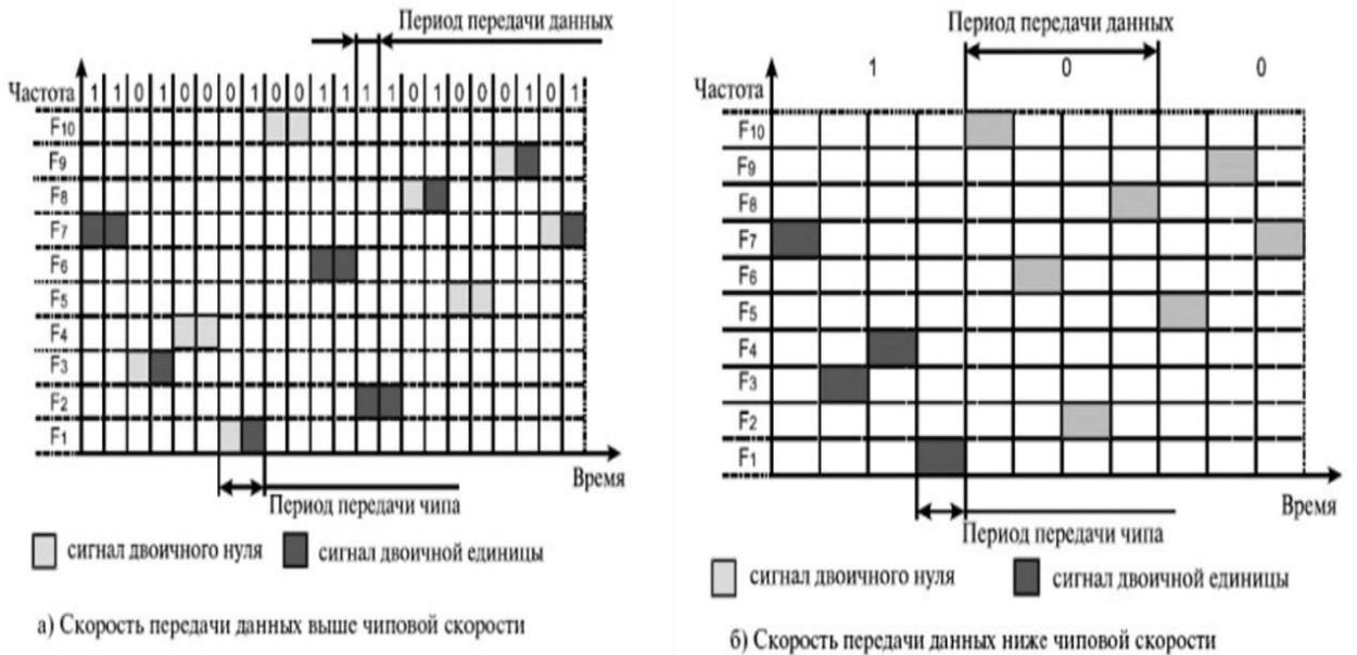
Рис. 1.4.4. Соотношение между скоростью передачи данных и частотой смены подканалов
