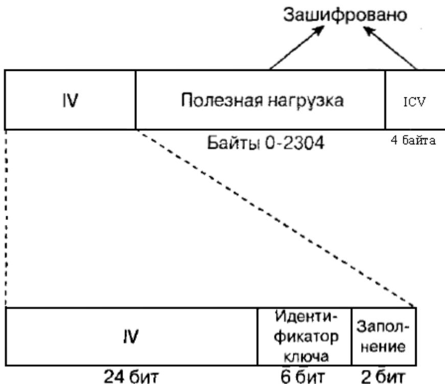
Рис. 21. Фрейм, зашифрованный алгоритмом WEP
