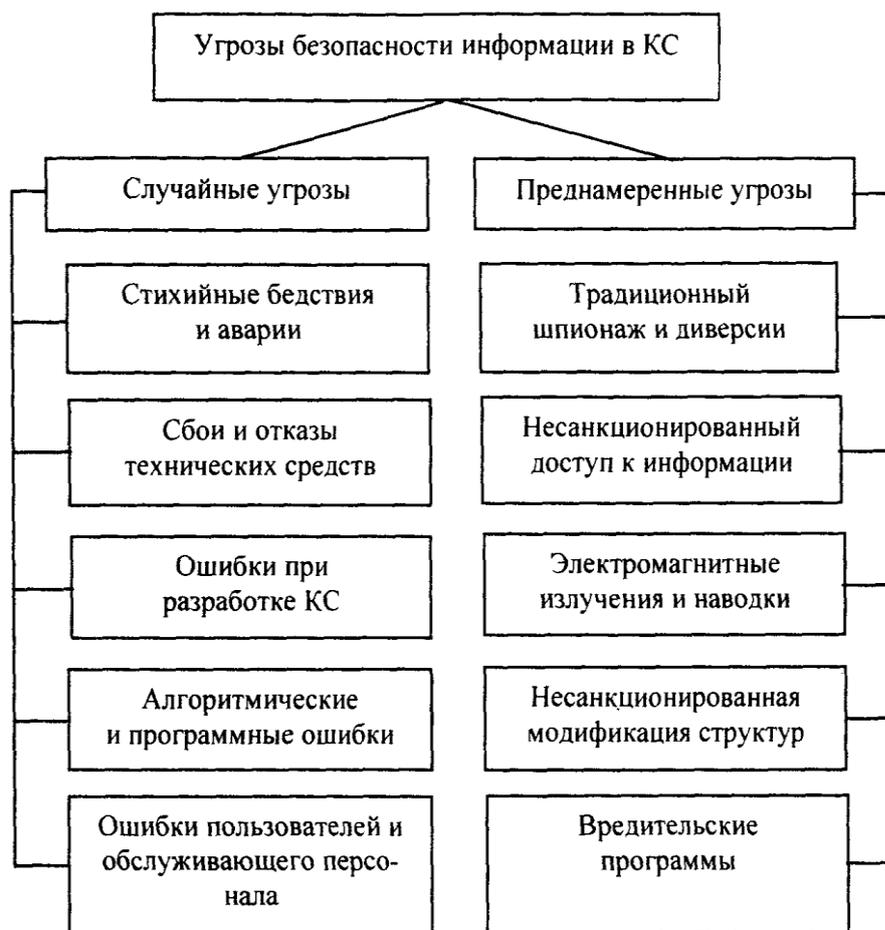
Рис. 10. Угрозы безопасности информации в компьютерных системах
