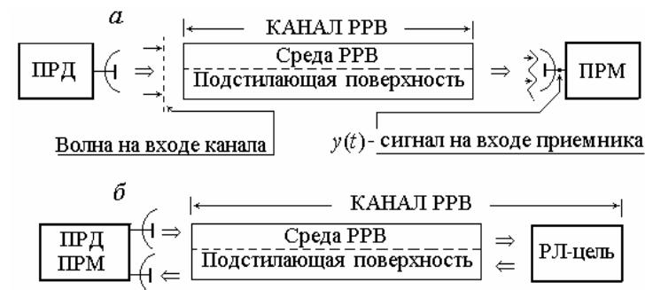
Рис. 2.1. Структура типичных радиоканалов: для РТС передачи информации (a); для измерительных РТС (б). ПРД — передатчик; ПРМ — приемник
