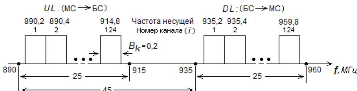
Рисунок 3 – Частотный план стандарта GSM-900
